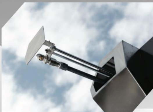
YOCW: Aplicación de cera mediante boquillas telescópicas
